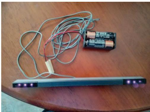
Figura 4: Barra de LEDs inalámbrica
